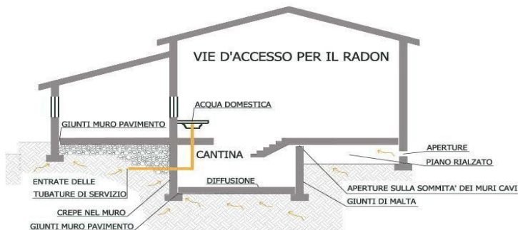
Figura 8: vie d'accesso per il radon
