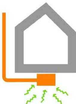
Figura 16: depressione del sottosuolo tramite pozzetto.
